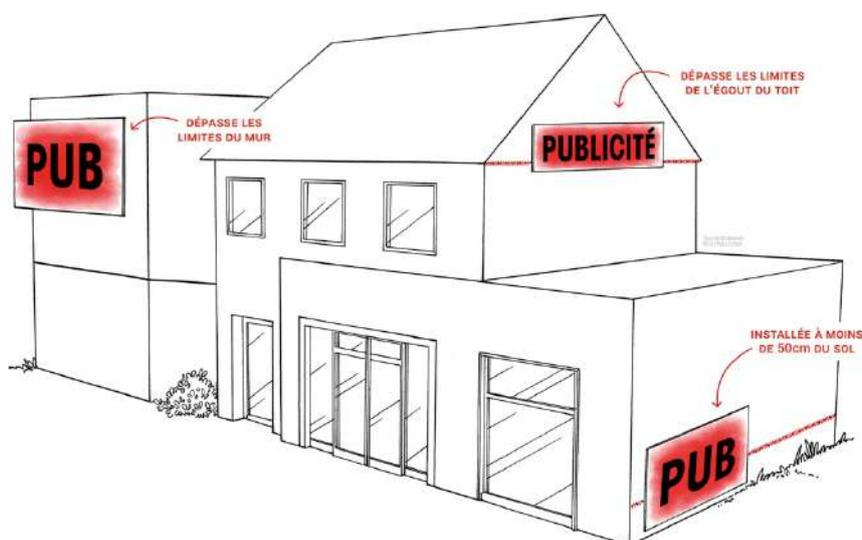
La publicité sur mur ou clôture doit être située sur le mur qui la supporte ou sur un plan parallèle à ce mur. Elle ne peut constituer par rapport à ce mur une saillie supérieure à 25 cm.
