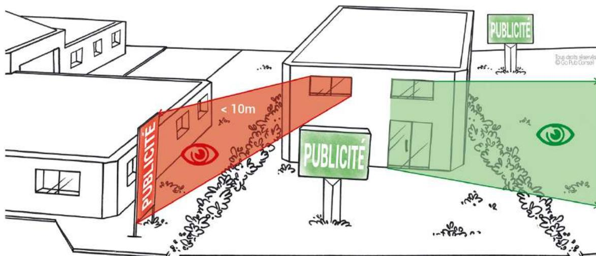
L'implantation d'un dispositif scellé au sol ou installé directement sur le sol non lumineux ne peut être faite à une distance inférieure à la moitié de sa hauteur d'une limite séparative de propriété.
