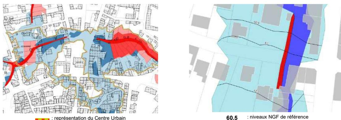
Par ailleurs, la prise en compte des risques d'inondation dans l'aménagement suppose une bonne connaissance des niveaux d'eau à prendre en compte par les porteurs de projets. C'est pourquoi la ligne d'eau de référence du PPRI, exprimée en niveaux NGF-IGN69, a été superposée au zonage réglementaire (figure ci-dessus).
