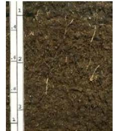
Des tableaux permettent la visualisation des résultats obtenus en fonction de la profondeur du sol. Le terme « *refus* » indique que le sondage à l'aide d'une tarière manuelle ne permet pas de descendre plus en profondeur à cause d'éléments grossiers (bloc de pierre, cailloux ou roche mère).
